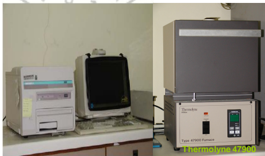
圖 3.2 Harshaw 3500 型熱發光劑量計讀儀
